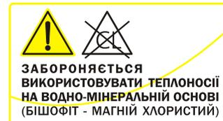
При перегріванні у теплоносії на основі бішофіту виділяються молекули хлору, які в свою чергу вступають в реакцію з нержавіючою сталлю, що призводить до хімічної корозії.
